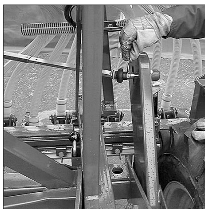
8. Приводной вал коробки приводной цепи установить и застопорить пружинным штекером.
