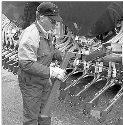
Рис. 6-3 Установка опоры для DT 6 м в вертикальное положение
